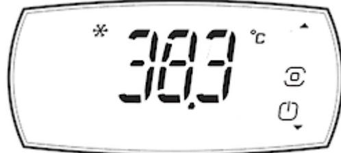
Condizione di allarme per temperatura elevata:
